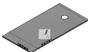
Positionner le receveur à son emplacement final. Installer la bonde et préparer la plomberie. Tracer le contour du receveur à l'aide d'un crayon pour la pose du silicone.
