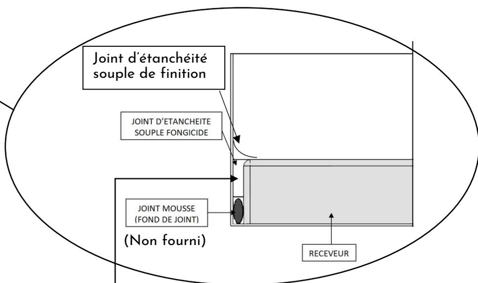
Mise en place du joint d'étanchéité souple de finition
